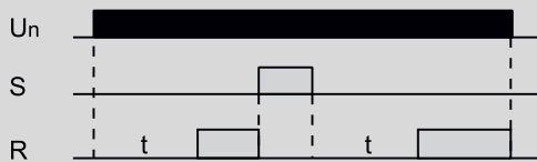
Диаграмма работы реле задержки включения ORT-A
