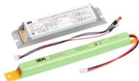
Блок аварийного питания (БАП) предназначен для обеспечения аварийного освещения помещений светодиодными светильниками и светильниками с люминесцентными лампами в случае непредвиденного отключения сети 230В. Блок аварийного питания ИЕК состоит из электронного пускорегулирующего аппарата (конвертера), герметичной аккумуляторной батареи, соединительных и управляющих элементов. Соответствуют требованиям ГОСТ Р МЭК 61347-2-13, ГОСТ Р МЭК 60598-2-22 (для аварийного освещения).
