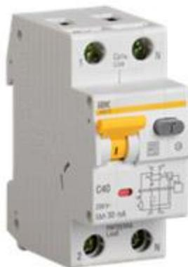
Автоматические выключатели дифференциального тока АДТ предназначены для защиты человека от поражения электрическим током при повреждении изоляции электроустановок, для предотвращения пожаров вследствие протекания токов утечки на землю и для защиты от перегрузки и короткого замыкания. Рекомендуются для защиты групповых линий, питающих розетки наружной установки, розеток и освещения подвалов и гаражей.
