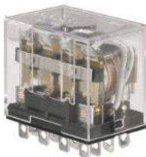
Реле промежуточные модульной серии РЭК77 и РЭК78 предназначены для передачи команд управления исполнительными элементами путем коммутации их электрических цепей своими переключающими контактами. Реле соединяются с розеточными модульными разъемами РРМ77 и РРМ78, устанавливаемыми на 35-мм монтажной DIN-рейке. На разъемах расположены зажимы выводов переключающих контактов и катушки. В реле применяются серебросодержащие контакты.
