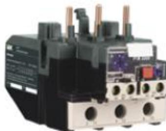
Реле электротепловое серии РТИ является электрическим коммутационным устройством, имеющим собственное потребление энергии. Электротепловое реле серии РТИ предназначено для защиты электродвигателей от перегрузки, асимметрии фаз, затянутого пуска и заклинивания ротора. Устанавливается непосредственно на контакторах серии КМИ. Для защиты от короткого замыкания должны быть предусмотрены предохранители или автоматические выключатели на соответствующее значение номинального тока срабатывания.
