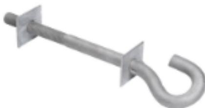
Кронштейны абонентские предназначены для фиксации абонентских ответвлений на стенах, опорах и фасадах зданий. Кронштейны болтовые предназначены для сквозной фиксации. Крюки позволяют осуществлять промежуточные и анкерные крепления на опорах и фасадах зданий. Поверхность крюков и болтовых кронштейнов покрыта слоем цинка 80 мкм, что позволяет уверенно эксплуатировать их в течение 40 лет.
