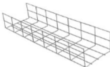
Проволочные лотки предназначены для прокладки силовых и информационных кабелей внутри зданий и сооружений. Чаще всего используются под фальш-потолками. Отличительной особенностью прокладки кабеля при помощи проволочных лотков является удобство монтажа с использованием минимального количества аксессуаров, а также отличная вентиляция проложенной кабельной трассы, что уменьшает вероятность ее перегрева.
