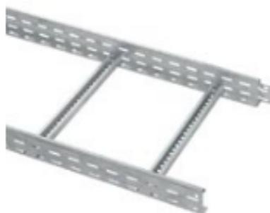
Лестничные металлические лотки из оцинкованной стали используются в монтаже трасс для прокладки проводов и кабелей при выполнении открытых электропроводок и открытой прокладки кабельных линий на промышленных и гражданских объектах. Лестничные лотки изготавливаются из рулонной холоднокатаной стали, оцинкованной горячим способом в агрегатах непрерывного цинкования (ГОСТ 14918-80).
